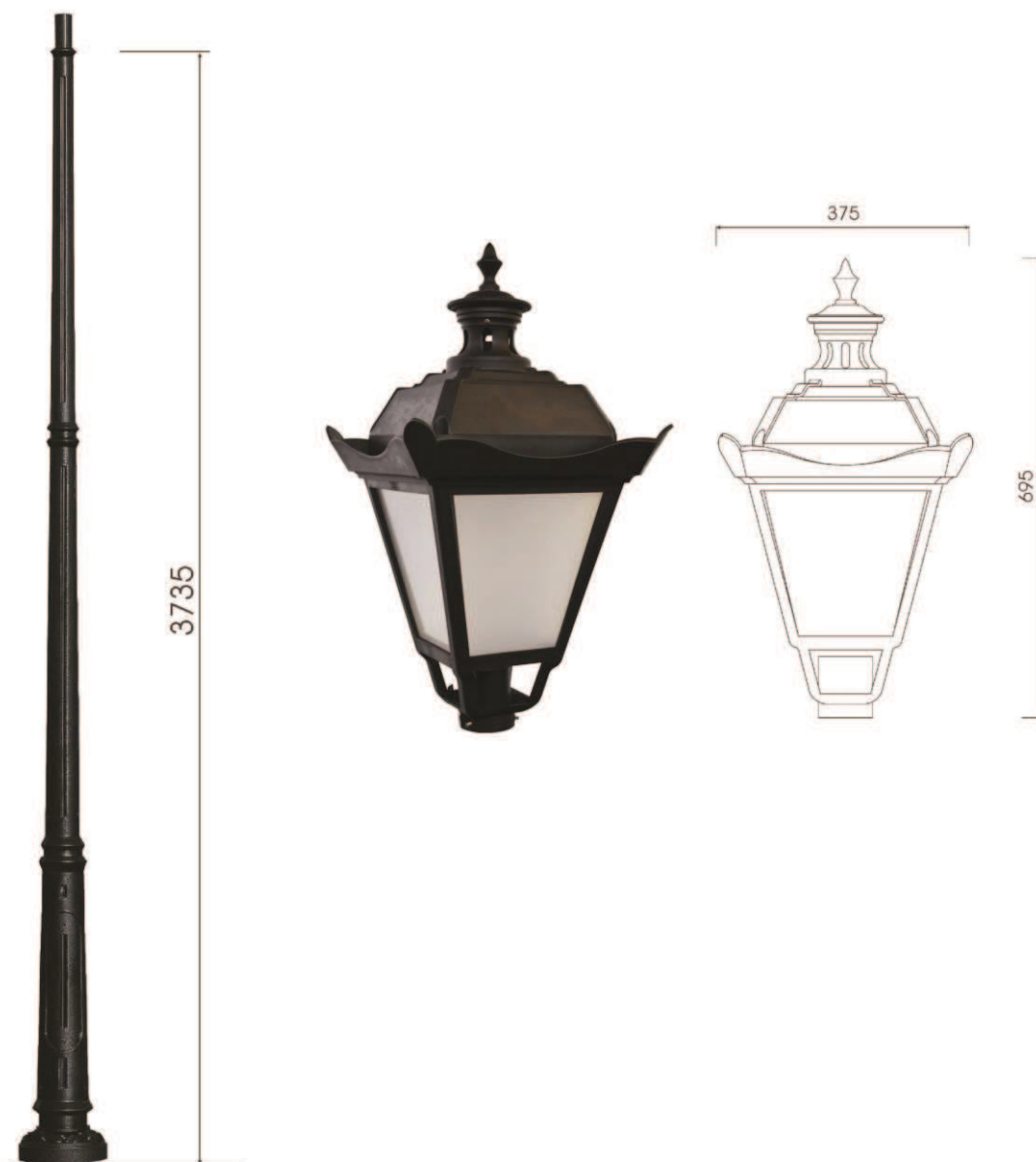
Ryc. nr 7 Mała architektura. Słup oświetleniowy i oprawy.
