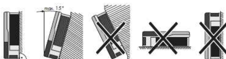
Rys.6 Wytyczne montażu falownika
